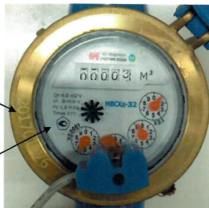
Рисунок 3 – Место нанесения знака утверждения типа и заводского номера на счётчики холодной и горячей воды крыльчатые многоструйные MBC
