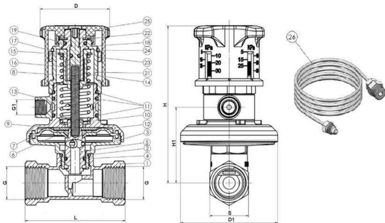
Рис.1 Клапан балансировочный автоматический латунный без измерительных ниппелей.
